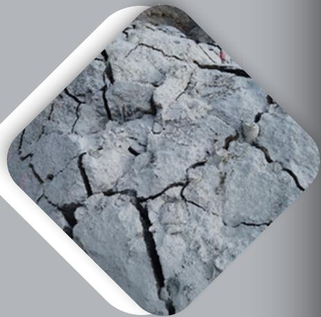
Suite à l'effet d'hydratation, le ciment génère une puissance expansive de plus de 7000 t/m<sup>2</sup>, alors que seules 2000 t/m<sup>2</sup> sont nécessaires pour casser les rochers les plus durs. La démolition se produit quelques heures après.
